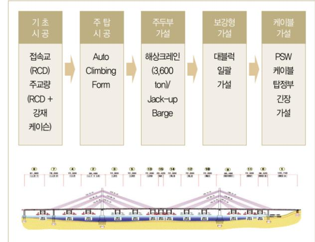
■ 현장타설 말뚝기초 시공 후 Bell Type 강재 우물통을 침설하여 콘크리트로 일체화시공한 주탑기초 위에 ACS(Auto Climbing Form System)을 이용하여 주탑을 시공한다. 주탑 시공 후 정착박스를 주탑에 설치하고 해상크레인과 Jack-up Barge를 이용하여 주두부, 측경간, 주경간을 단계별로 안정성 검토 후 선형관리 계획에 의해 보강형 가설 후 케이블 설치 공정을 반복하여 시공하게 되는데, 이 때 보강형의 종단 캠버를 확보하기 위하여 케이블 장력으로 조정한다. KEY SEG 설치가 완료되면 최종 장력 조정으로 종단 선형을 완성하게 된다.
