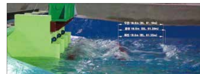
〈그림 7〉 제수문 하류부 유황 및 유속분포(200년빈도 홍수조절, baffle pier 2열 설치)
