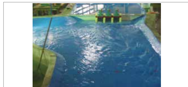
〈그림 6〉 제수문 하류부 유황 및 유속분포(200년빈도 홍수조절, 감세공 미설치)
